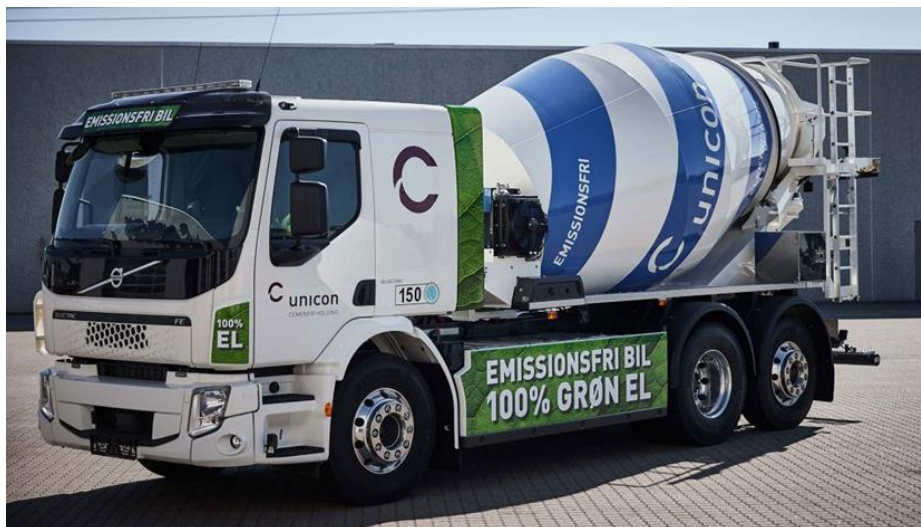
Figuur 13 De Hoop Terneuzen heeft geïnvesteerd in een volledig elektrische betonmixer.
